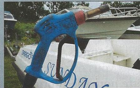
L'extrémité du tuyau est composée d'un pistolet avec une buse.
