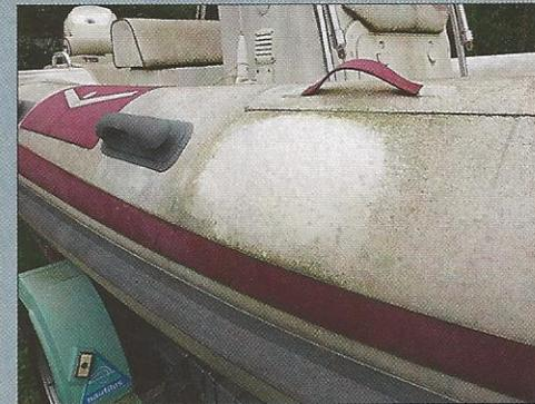
Les flotteurs des semi-rigides, piqués par les champignons, n'ont pu être retirés.
